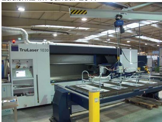
Laseranlage mit Vakuumhebevorrichtung
